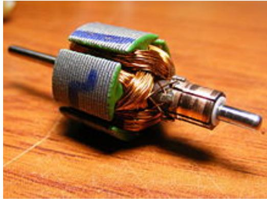
Rotor de una pequeña máquina de corriente continua de 12 V, con imanes permanentes, de dos polos, cinco devanados, cinco delgas y dos escobillas
