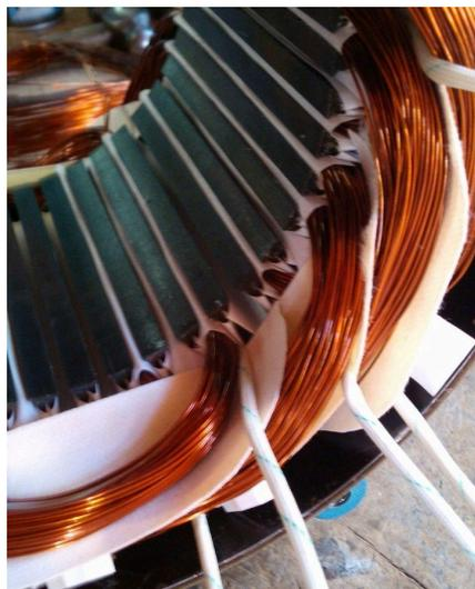
Bobinas en las ranuras del estator
